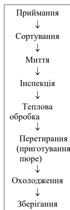
Рис. 1. Технологічна схема виробництва пюре з кореня селери
