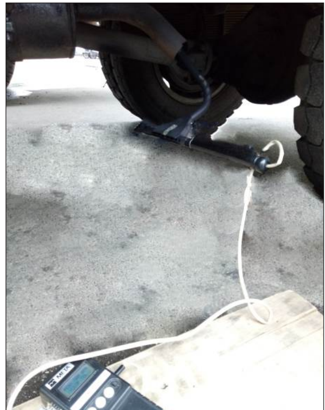
Рис. 9. Перевірка димності ВГ автомобіля з дизелем, що працює за дизельним та газодизельним циклами
